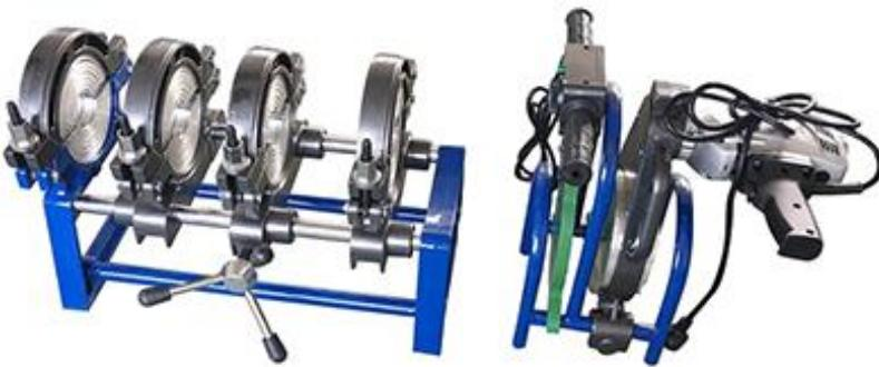
**Механический стыковой сварочный аппарат SUD 63-250 М4** с четырьмя захватами. Предназначен для монтажа труб из полиэтилена (высокого и низкого давления) и полипропилена.
